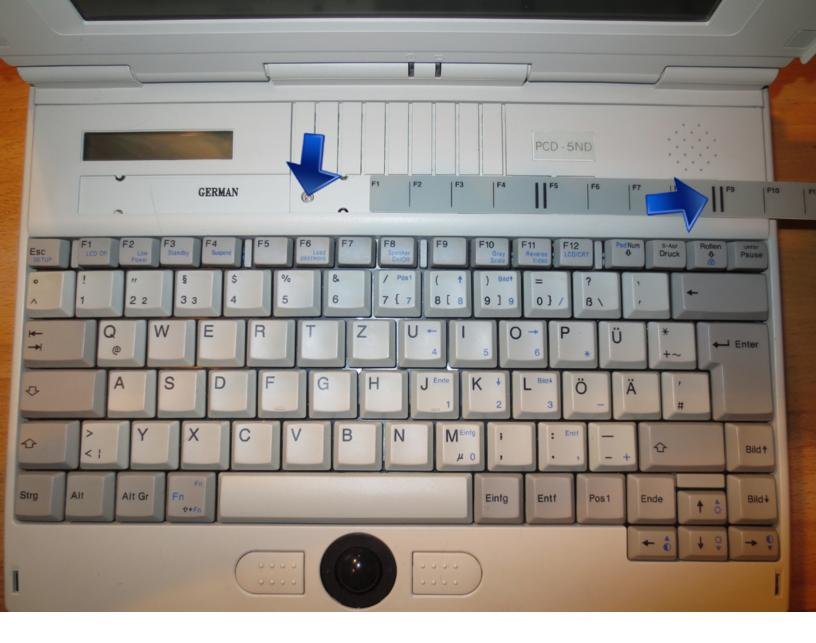
Drehen Sie das Gerät nun um, klappen Sie es vorsichtig auf (das Display ist bereits lose), entfernen Sie das Plastik über der Tastatur.
