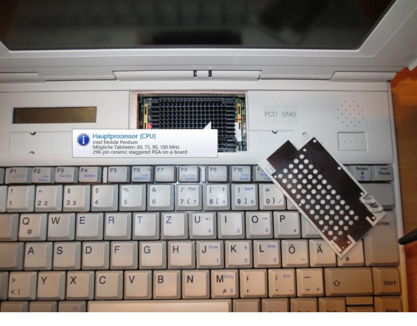
Hier versteckt sich noch eine Schraube, die wie abgebildet zu entfernen ist, um die CPU freizulegen.
