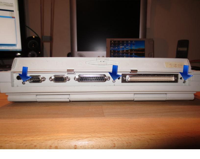
Entfernen Sie nun wie oben abgebildet die drei Schrauben, die den Tastaturrahmen hinten befestigen.
