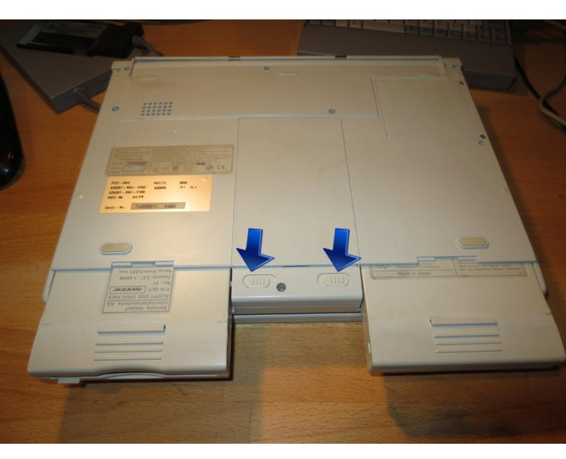
Beginnen Sie mit der Entnahme des Diskettenlaufwerkes und des Akkus, entriegeln wie abgebildet.
