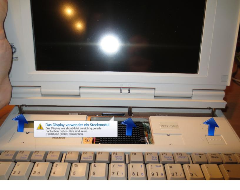
Nun heben Sie das Display gerade nach oben, um die Steckverbindung zu lösen. Das Display ist ein Modul, somit leicht zu entfernen.
